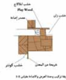
طريقة تركيب وحدة العرض والإضاءة مقياس 1:20
